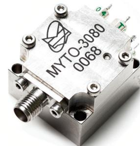
ЖИГ-генераторы МУТО-3080 и МУТО-40100 — рекордсмены по совокупности фазовой стабильности и диапазона перестройки частоты. Они способны сохранять умеренно низкий фазовый шум сигнала при перестройке частоты более чем в три раза. Этот эффект достигается благодаря использованию монокристаллического ферромагнитного резонатора из железо-иттриевого граната.
